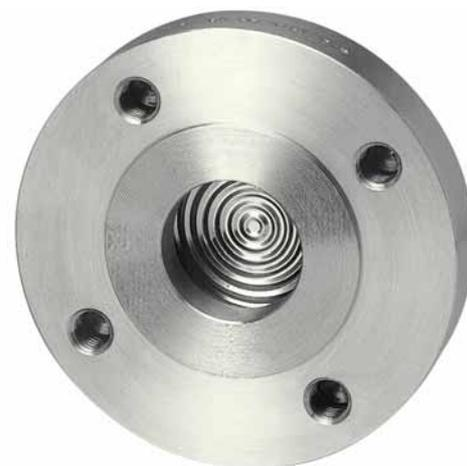
Realizados para aislar el elemento sensible de los manómetros, presostatos y transmisores electrónicos de presión, de fluidos de proceso corrosivos, viscosos, sedimentosos, cristalizables y con altas temperaturas y presión. Una membrana soldada y puesta a prueba antifugas, garantiza la separación del fluido de transmisión del proceso. Las conexiones bridadas según norma ASME-EN1092 nos permite su implantación en instalaciones químicas y petroquímicas, tratamiento de agua y papeleras.
